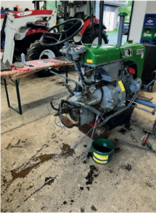
Der vordere Teil des T80. Hier waren bis auf den Tausch von zwei verschlissenen Simmerringen keine Arbeiten notwendig. (Foto: Gilbert Haas)
