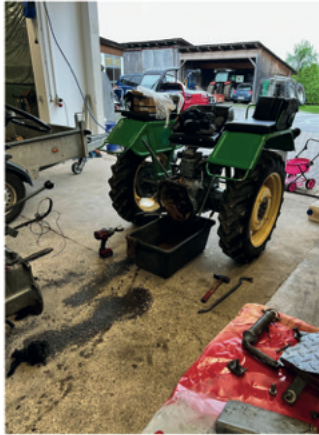
Beim Hinterachsgetriebe wurden die neuen Zahnräder eingebaut. (Foto: Gilbert Haas)
